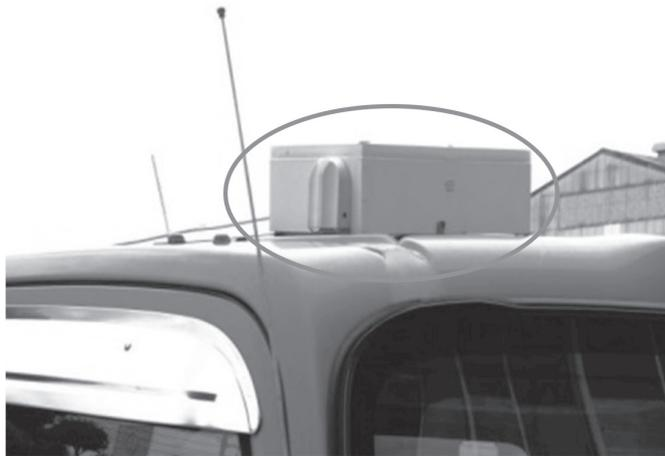
写真5 気温や大気物質等をGPSと連携させながら測定する装置
